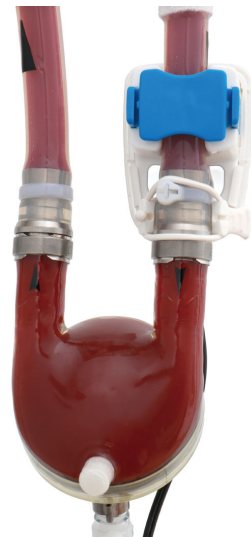
10mL血液ポンプに流量センサーを装着
